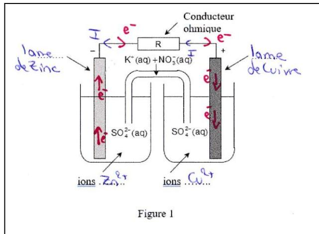
1.2. A L'électrode de zinc, les électrons sont libérés il y a donc une oxydation.
